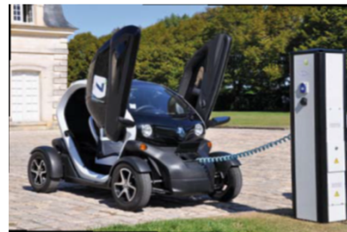
Borne électrique de recharge
