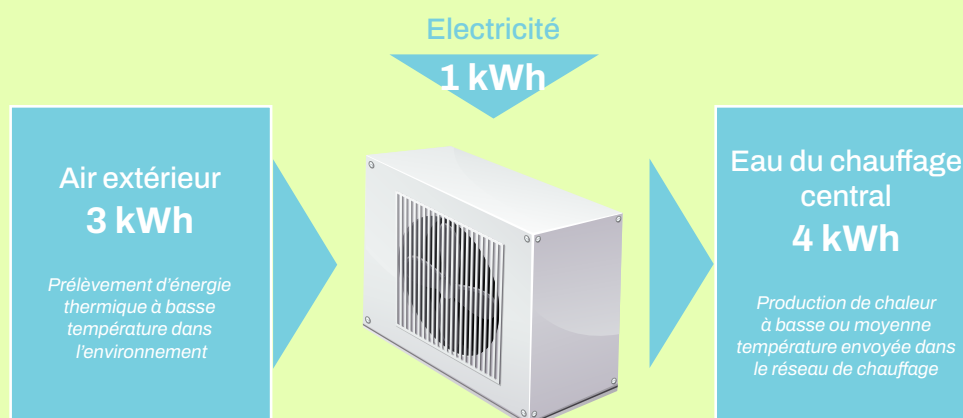
Principe de fonctionnement d'une PAC
